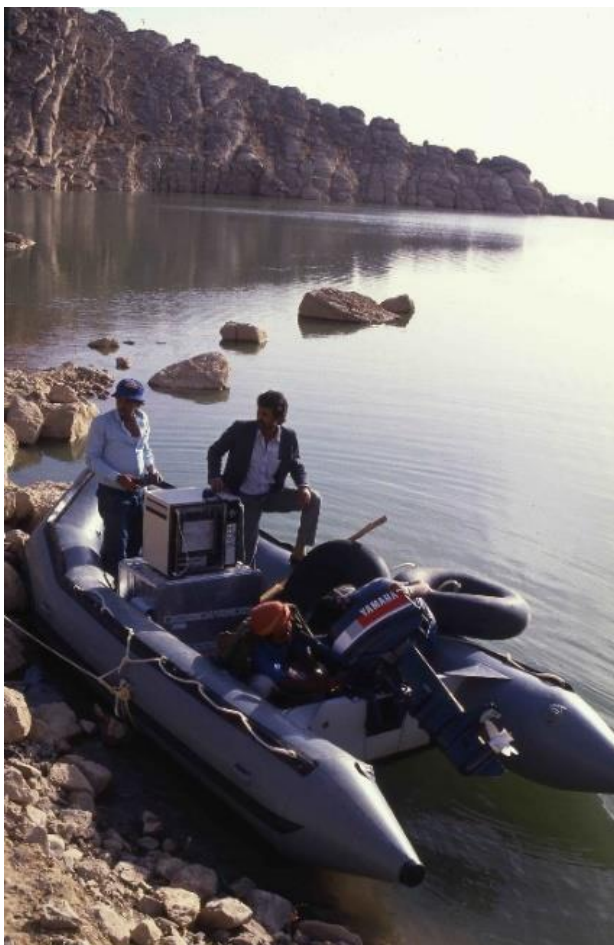
Bathymetrie op het stuwmeer bij Marib, WRAY, 1989 (Foto: F.C. Dufour) Hiermee werd met een echo-recorder de dikte gemeten van de recente sedimentlaag die zich in het meer had gevormd gedurende de periode 1986-1988 (sinds de constructie van de nieuwe Marib dam). Daarmee werd een eerste indruk verkregen van de mogelijke levensduur van het reservoir.
