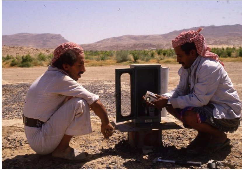
Uitlezen van een grondwaterstandsrecorder bij Marib, WRAY, ca 1987 (Foto: F.C. Dufour) Het registreren van grondwaterstandsvariaties in de tijd is een hulpmiddel om de dynamiek van het grondwater te leren kennen, onder invloed van grondwateraanvulling, natuurlijke afvoer en grondwateronttrekking.
